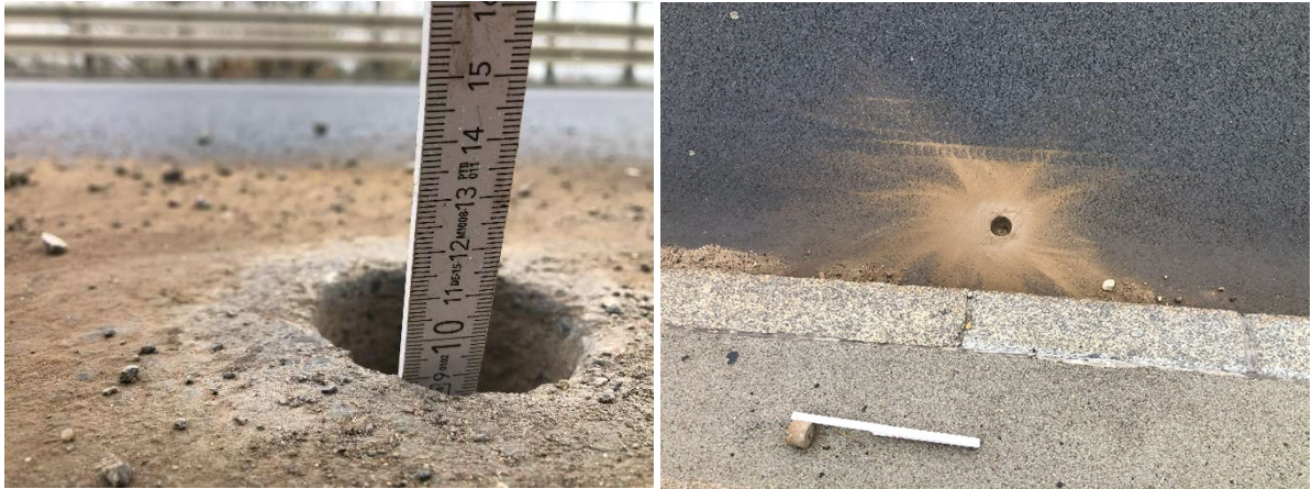
Fot. 69 Odwiert rdzeniowy nawierzchni mineralno-bitumicznej
